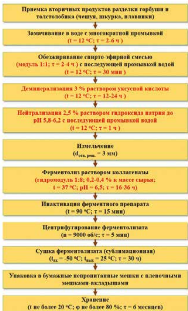
Рисунок 3. Модифицированная технологическая схема производства ферментализатов из вторичных продуктов разделки рыб
