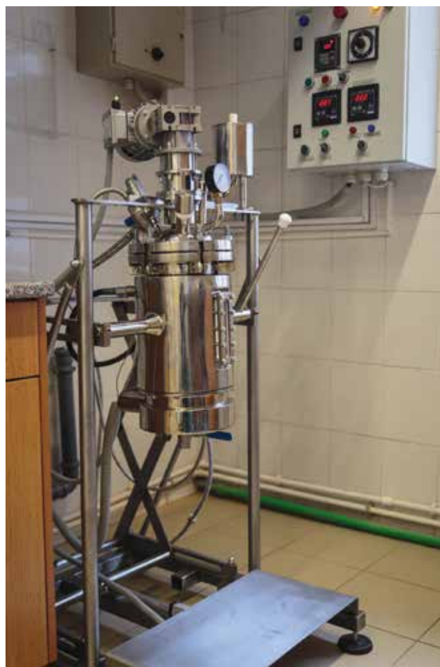
Рисунок 2. Модельная установка для комплексной переработки вторичного рыбного сырья
