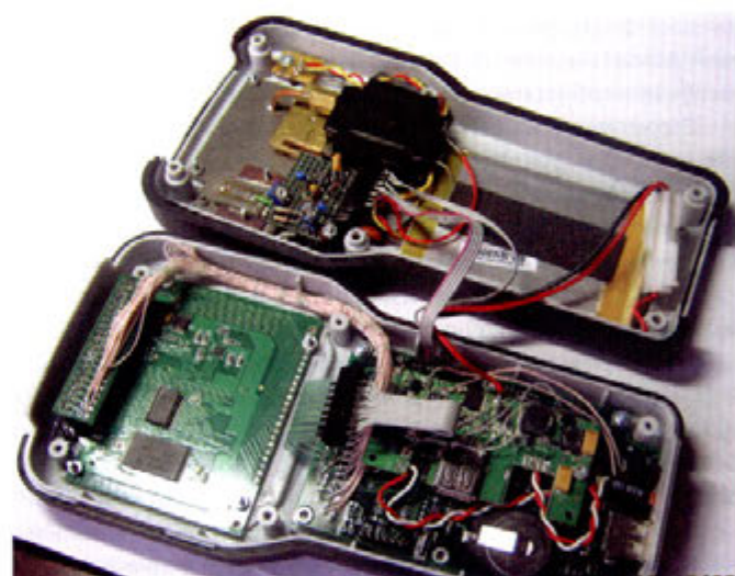
Рис. 4. Измеритель жирности рыбы ИЖ-01 с открытой задней крышкой
