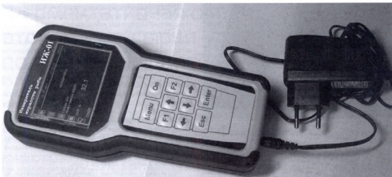
Рис. 3. Измеритель жирности рыбы ИЖ-01
