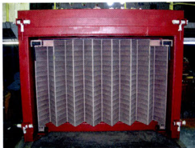
Рис. 4. Комбинированное двухконтурное РЗУ, разработанное и изготовленное ООО «Осанна», для водозабора МЛСП «Приразломная», Приразломное месторождение, Печорское море
