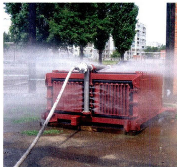
Рис. 3. Жалюзийные РЗУ с потокообразователем, разработанные и изготовленные ООО «Осанна» для водо-приемников платформ ПА-Б и ЛУН-А, Пильтун-Астохское и Лунское месторождения, Охотское море
