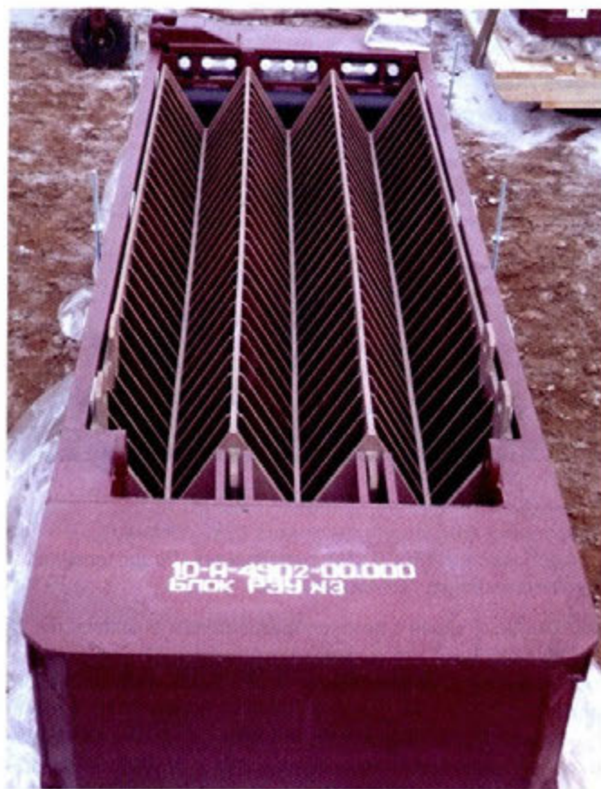
Рис. 5. Комбинированные двухконтурные РЗУ для Центральной технологической платформы (ЦТП) (слева) и Ледостойкой стационарной платформы (ЛСП-1) (справа), месторождение им. В.В. Филановского, Северный Каспий. Разработчик и изготовитель ООО «Осанна»
