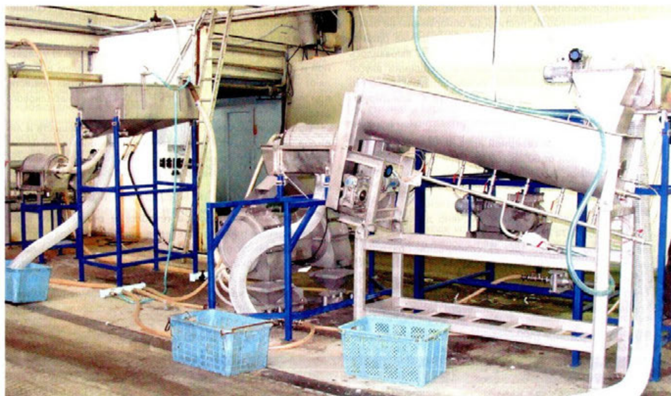
Рис. 4. Линия (ИЛАМ) получения очищенного мяса из мелких креветок
