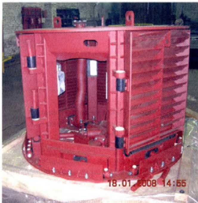
Рис. 2. Жалюзийное РЗУ с потокообразователем в виде прямой шестигранной призмы для СПБУ «Арктическая», Печорское море. Разработчик и изготовитель ООО «Осанна»
