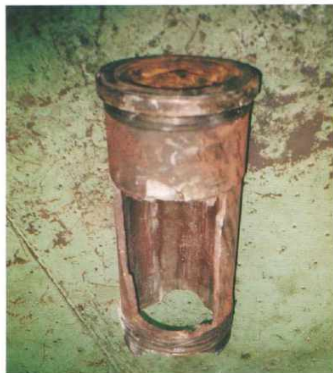
Рис. 4. Разрушенная цилиндровая втулка
