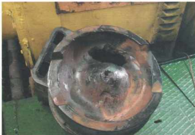
Рис. 5. Повреждения поршня цилиндра № 5 дизеля 6ЧН 18/22-215
