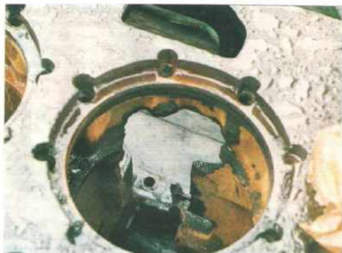
Рис. 1. Разрушенный цилиндрический блок
