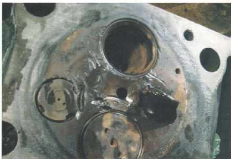
Рис. 6. Повреждения днища крышки цилиндра № 5 дизеля 6ЧН 18/22-215.
