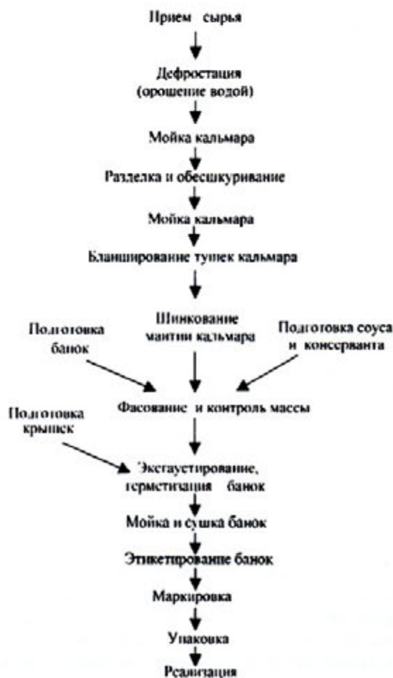
Рис. 8. Технологическая схема производства малосоленых пресервов из бланшированного полуфабриката кальмара
