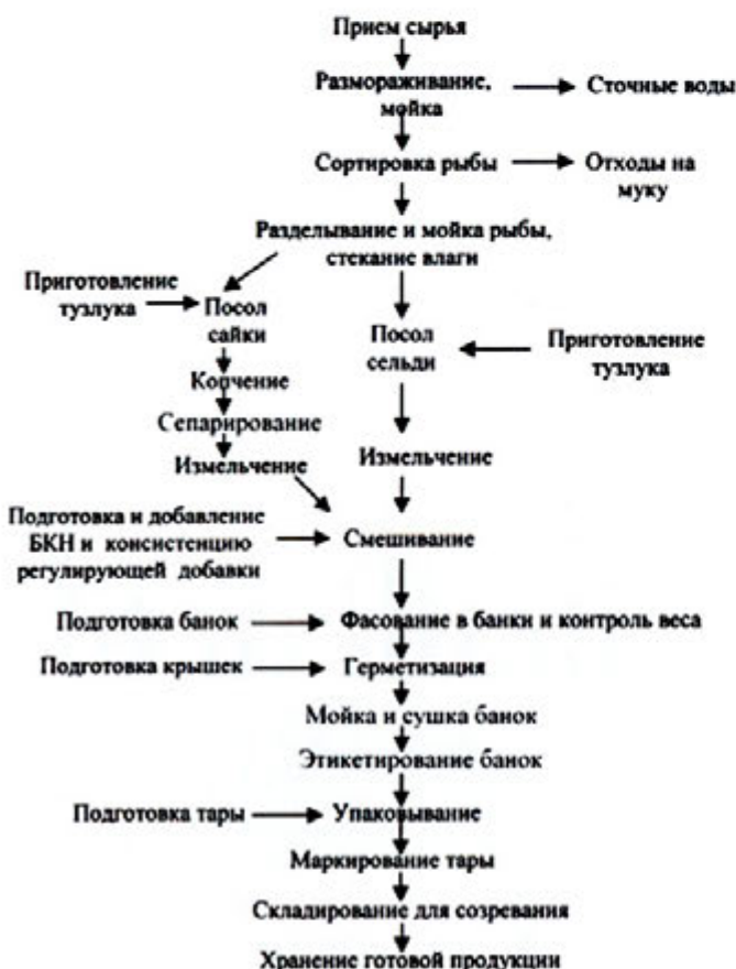
Рис. 1. Технологическая схема производства пресервов типа паштеты
